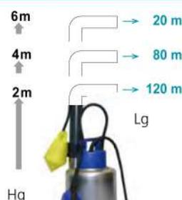
Longueur maxi du refoulement (Lg) Ø 40 en fonction du dénivelé du terrain (Hg) pour un débit de **3m<sup>3</sup>/h**.
